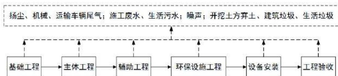
图 2.2-1 项目施工期产污环节图
